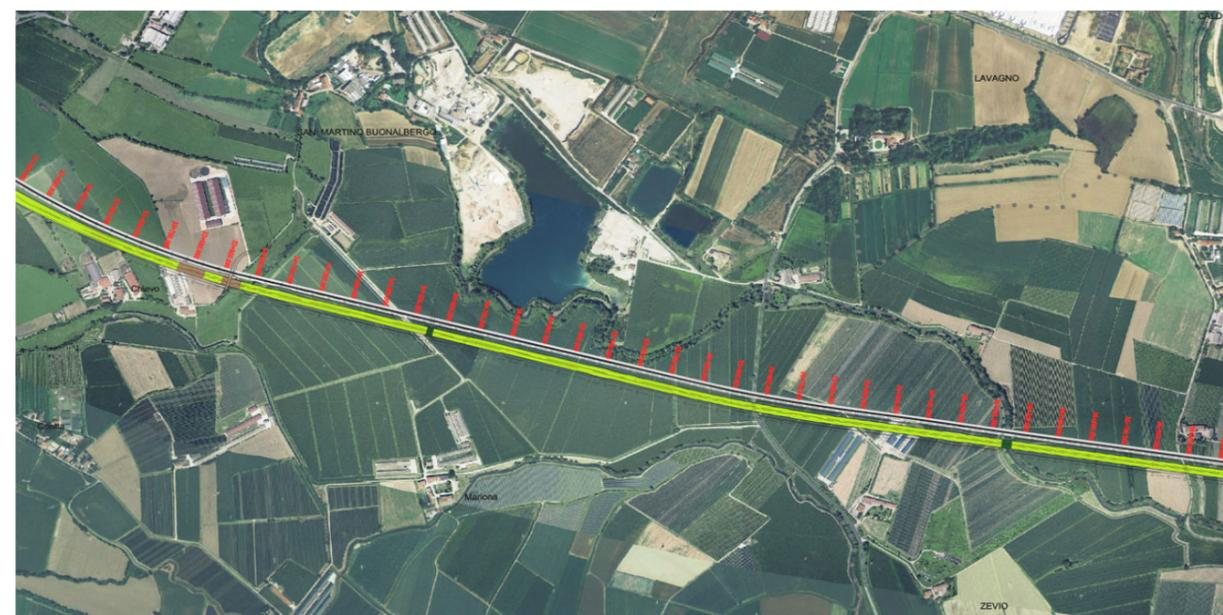
In corrispondenza della progressiva km 38+600 c.a., l'infrastruttura di progetto prosegue in leggera trincea (3.0-4.0m dal piano campagna) per sottopassare con una galleria artificiale il futuro corridoio della linea TAV, per poi continuare, in aderenza dello stesso corridoio questa volta invece sul lato nord.
