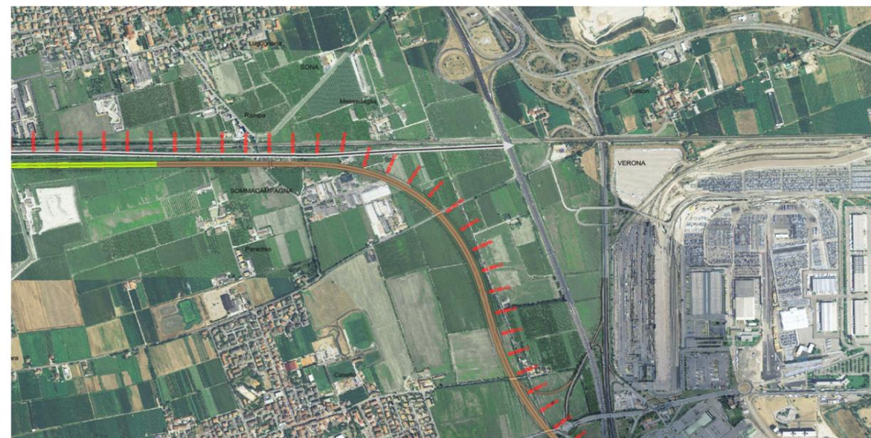
Il tracciato prosegue mantenendosi in rilevato sempre in aderenza alla linea ferroviaria MI-VE fino alla progressiva km 15+400 c.a., da dove inizia a scendere in trincea per poi, superata sulla destra al km 16+100 una zona industriale, curvare verso sud e mantenendosi parallelo all'Autostrada A22 intercettarla all'altezza del km 18+130 mediante un sottopasso autostradale. Alla progressiva 18+500 il tracciato è attraversato dalla galleria artificiale della SS 62.
