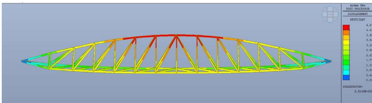
Figura 35: rappresentazione degli spostamenti
