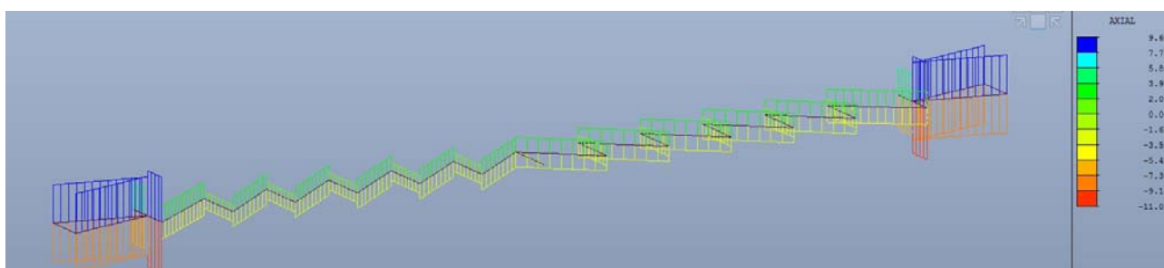
Figura 36: rappresentazione degli sforzi assiali nei profili diagonali inferiori
