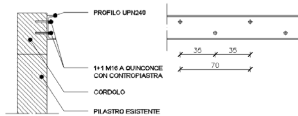
Figura 22: Dettaglio relativo al rinforzo operato nel cordolo sommitale in c.a.
