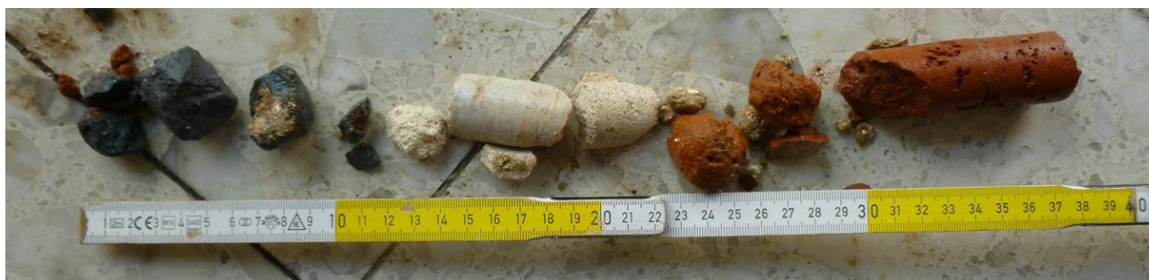
Figura 2.57: composizione della parete come documentata dal carotaggio C1 (foto tratta dalla relazione di Expinsrl)
