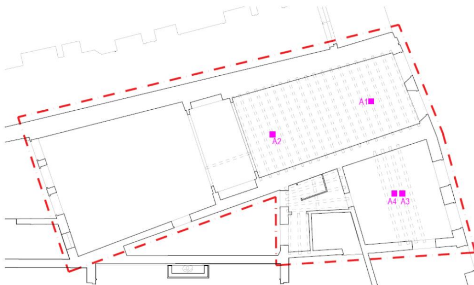
Figura 2.92: localizzazione delle travi indagate ai fini della classificazione a vista secondo UNI 11119/2004 (immagine tratta dalla relazione di Expin srl)
