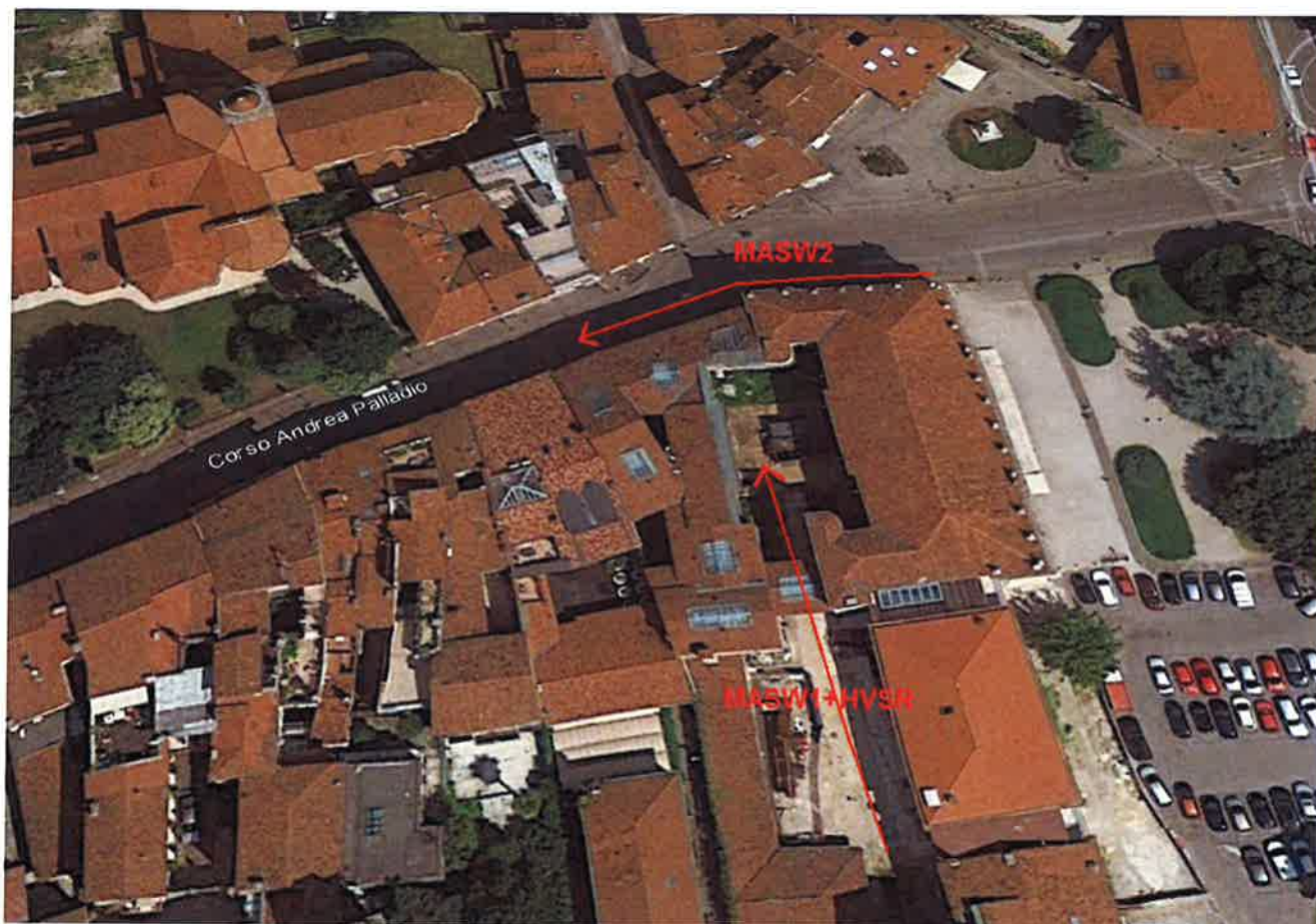
Figura 1 – Planimetria dell'edificio con ubicazione delle indagini. In rosso sono riportate le Masw eseguite nell'anno 2013, in azzurro quelle del 2016
