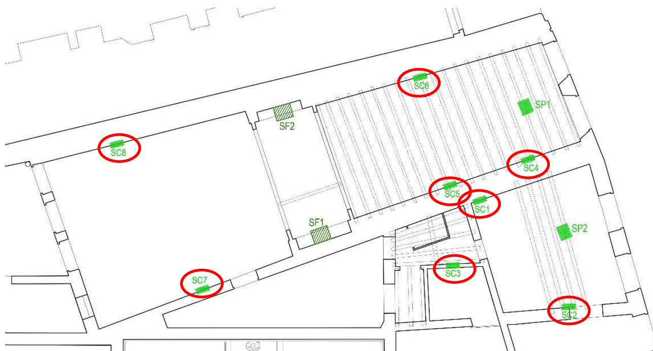
Figura 2.12: pianta del piano terra (disegno tratto dalla relazione di Expin srl) ove sono state evidenziate in rosso le posizioni degli 8 saggi mediante scarifica della muratura eseguiti tra maggio ed agosto 2016
