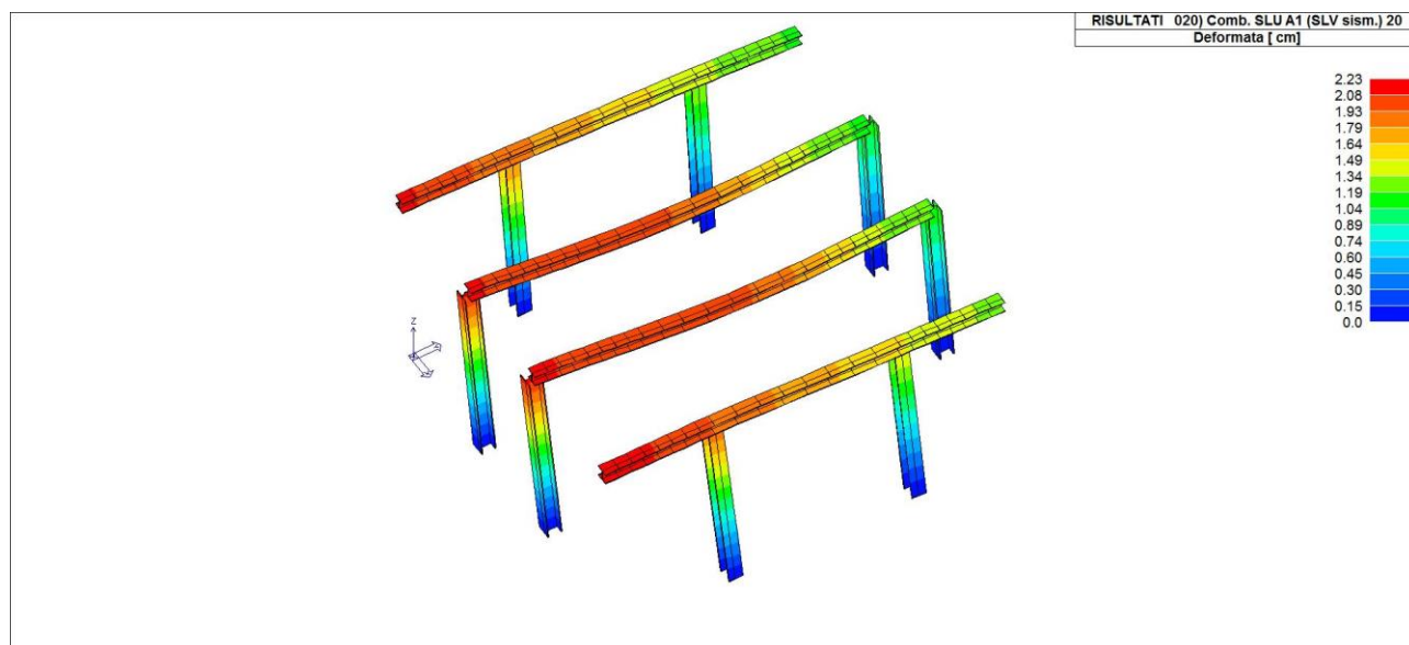
Figura 6.14 Deformata massima dovuta all'analisi dinamica lineare – comb.SLV
