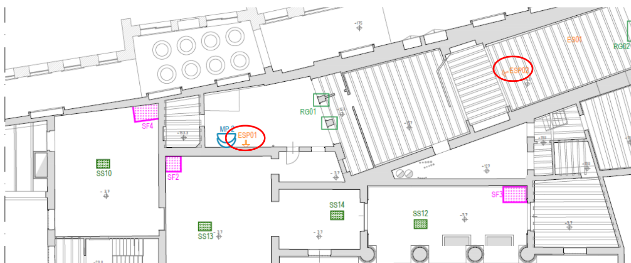
Figura 2.55: pianta del piano terra (disegno tratto dalla relazione di Expin srl) ove sono state evidenziate in rosso le posizioni delle prospezioni video endoscopiche eseguite tra novembre e dicembre 2016
