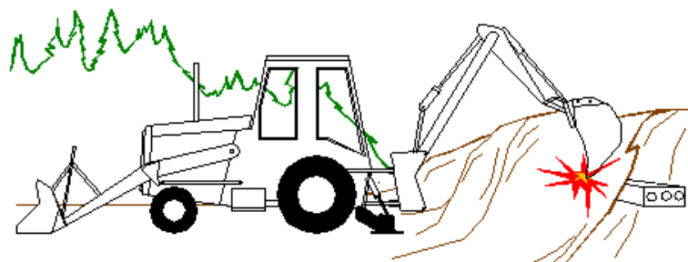
Figura 1 – Contatto con linee elettriche interrate
