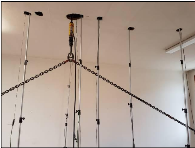
Prova di carico a tiro sul solaio M
