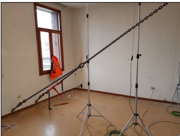
Catene di tiro ancorate alle murature
