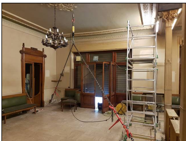
Prova di carico a tiro sul solaio B
