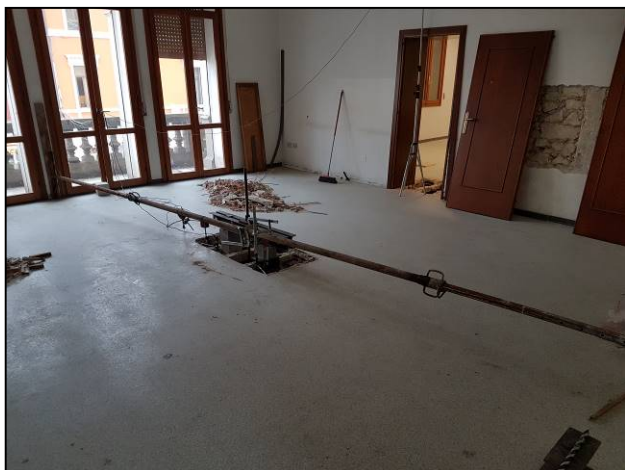
Elemento per l'applicazione del carico e sistema per il rilievo degli spostamenti
