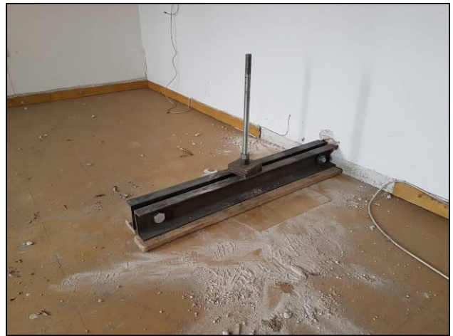
Elemento per l'applicazione del carico
