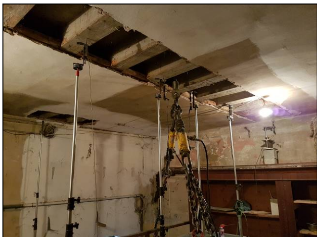
Prova di carico a tiro sul solaio E
