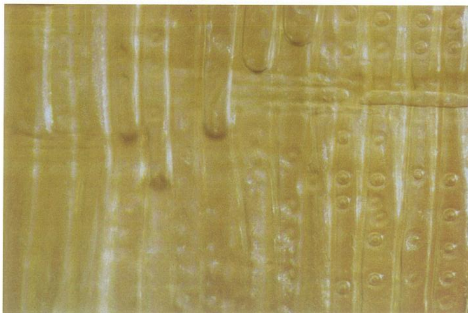
Foto n° 2. Si osservano le punteggiature areolate nelle pareti radiali delle tracheidi. Sezione radiale, luce riflessa, 200 X, N//.
