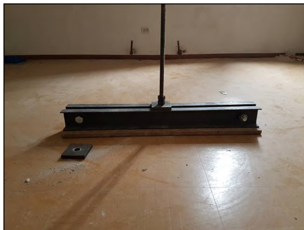
Elemento per l'applicazione del carico
