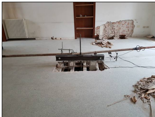
Elemento per l'applicazione del carico e sistema per il rilievo degli spostamenti
