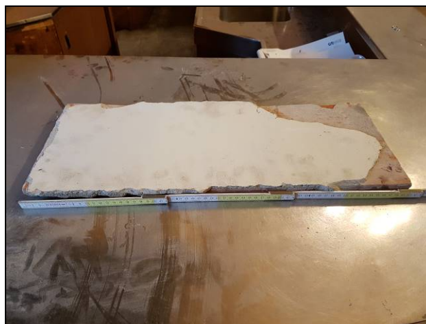
Tavella "a spacco" intonacata del solaio E
