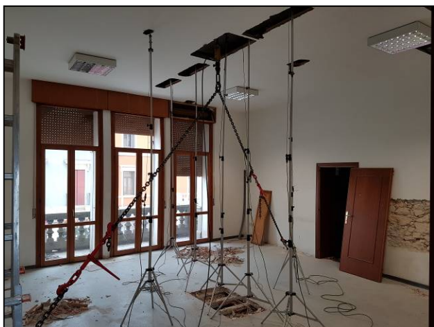
Prova di carico a tiro sul solaio I
