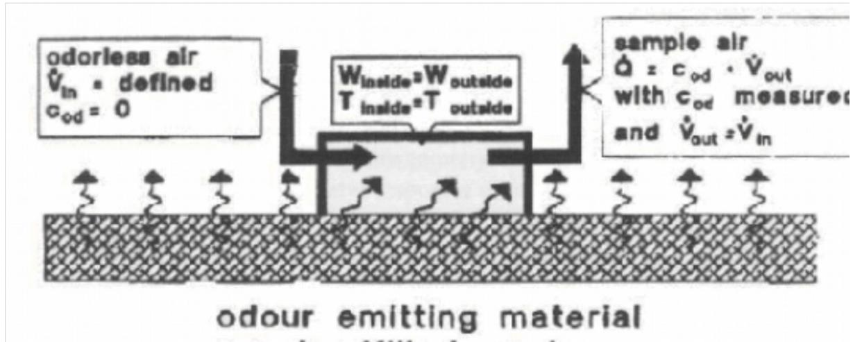
Allegato A.2 – Figura Schema di funzionamento di una cappa per il campionamento da superfici areali passive
