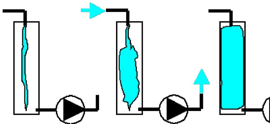
Allegato A.2 - Figura Schema di campionamento con pompa a depressione
