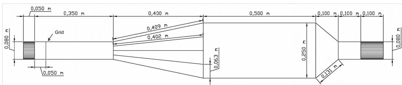
Allegato A.2 - Figura Esempio di pianta di una wind tunnel
