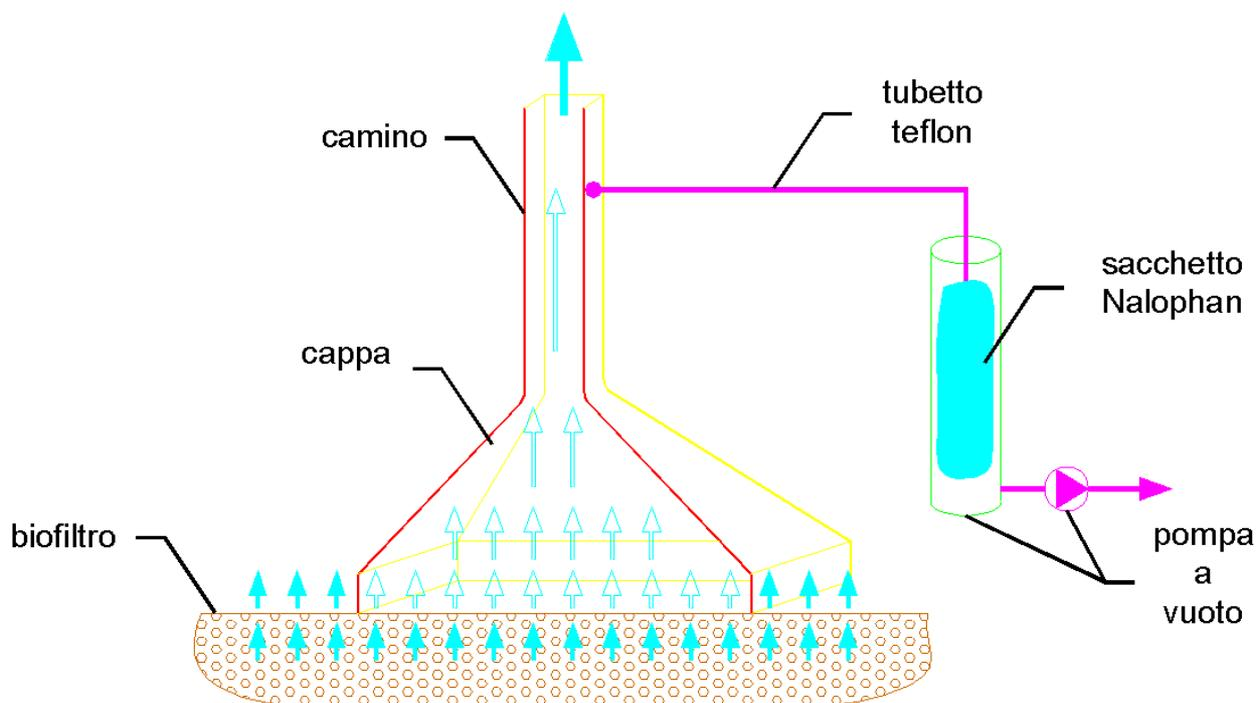
Allegato A.2 - Figura Schema di campionamento da sorgente areale attiva (biofiltro)
