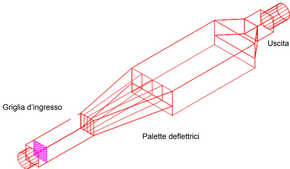
*Allegato A.2 - Figura Esempio di vista tridimensionale di una wind tunnel*
