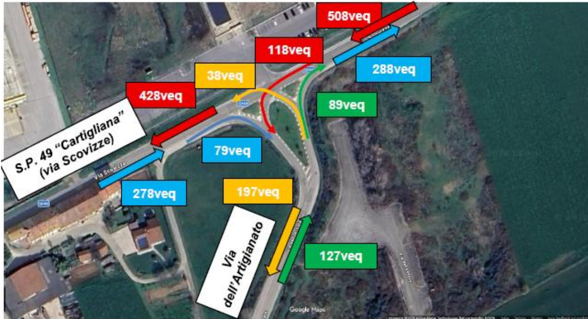
Figura 83: Volumi di traffico attuali registrati nell'ora di punta (07:00 – 08:00, veicoli equivalenti) in corrispondenza della S.P. 94 "Cartigliana" (via Scovizze) e via dell'Artigianato
