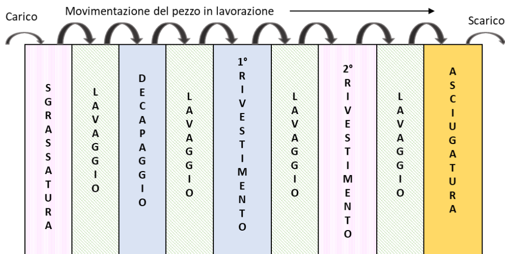
Figura 7: Linea di processo semplificata
