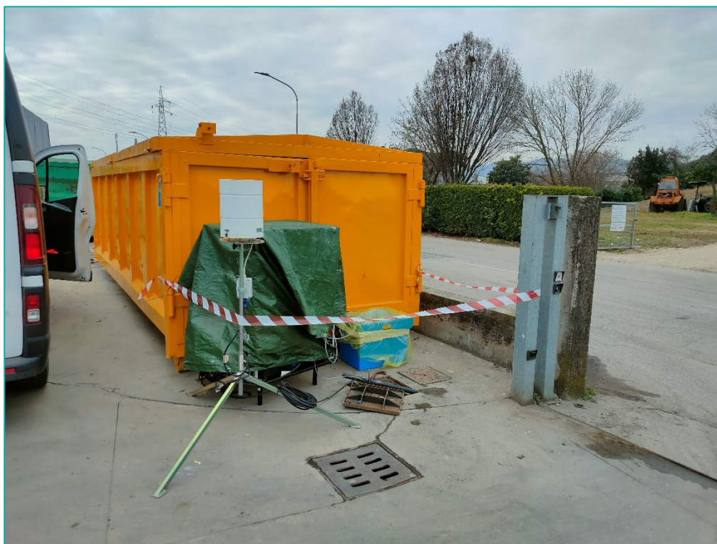
Figura 6 – Stazione di campionamento acque meteorico presso la rete di drenaggio dei piazzali prospicienti via I Maggio
