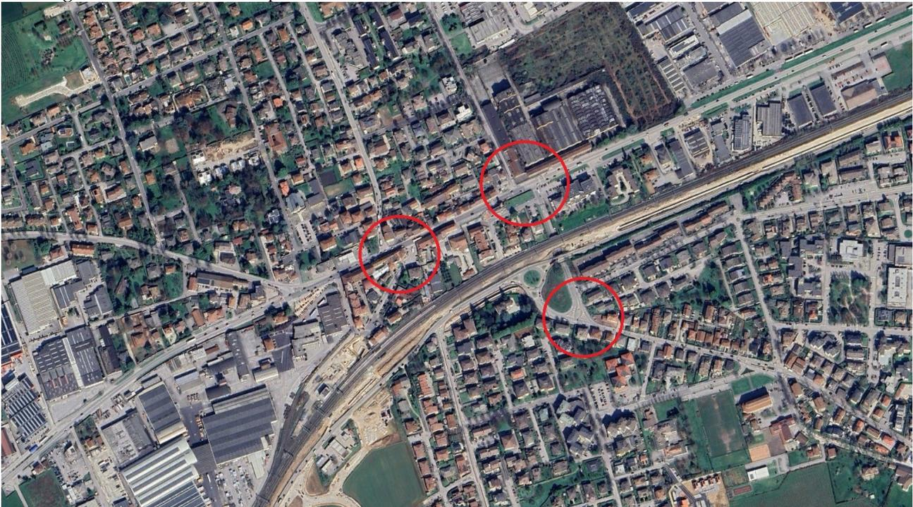
Attualmente la regolazione dei flussi di traffico è affidata ad un impianto semaforico per la prima rotatoria e ad un'intersezione con precedenza/stop per la seconda. Per mediare all'elevato traffico transitante nella viabilità dell'area di interesse occorre la progettazione di due rotatorie apporteranno i seguenti vantaggi:
