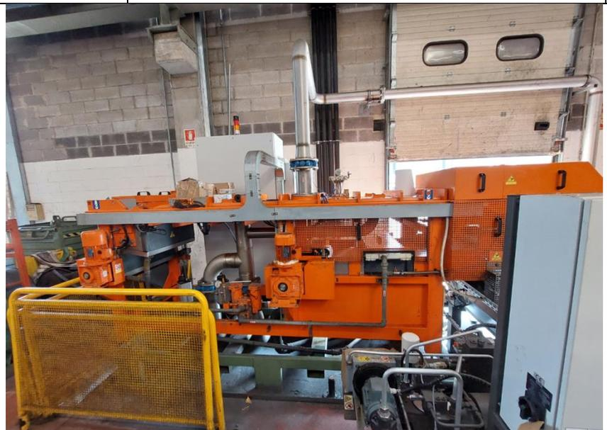
**Fig. 4** - Dispositivo per la filtrazione in pressione della emulsione oleosa e il compattamento in "bricchetti" metallici dei residui di lavorazione.
