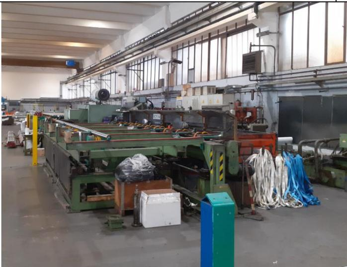
**Fig. 11** – Lucidatura (o Pulitura) del semilavorato  Cromato  mediante nastri (in emulsione) e spazzole (a secco) con ASPIROFILTER e LOSMA in Capannone 2 (3 macchine)
