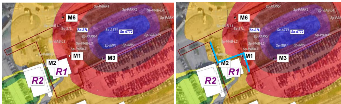
Figura 12-4 Emissioni acustiche diurne Attività 2 di cantiere (a sinistra) e variazione delle stesse con applicazione barriera fonoassorbente lungo perimetro ovest
