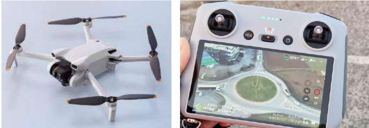
Le manovre sono state rilevate attraverso l'utilizzo di un drone DJI Mini 3 dotato di telecamere ad alta definizione, utilizzato per una ripresa aerea e la realizzazione di video finalizzati alla ricostruzione della matrice origine destinazione tramite apposito software.
