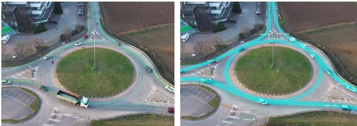
Figura 25 – particolare software di elaborazione – traiettoria veicoli
