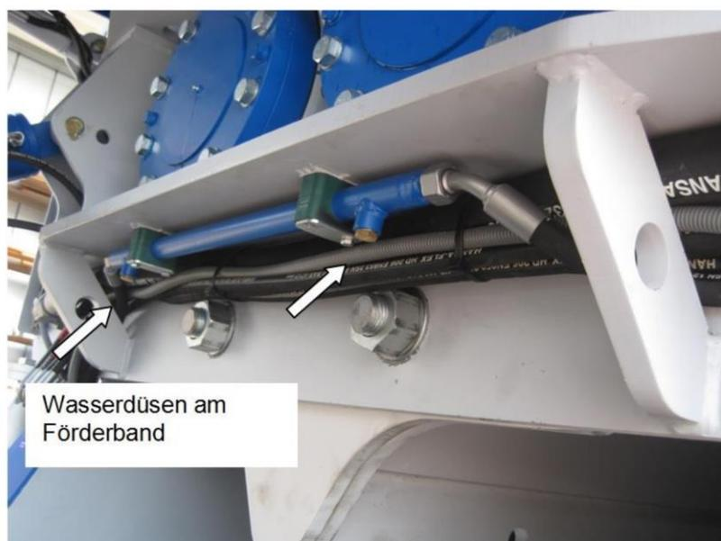
Il trituratore LINDNER può essere dotato come opzione con degli ugelli dell'acqua. Essi servono per minimizzare l'accumulo di polvere durante l'esercizio.
