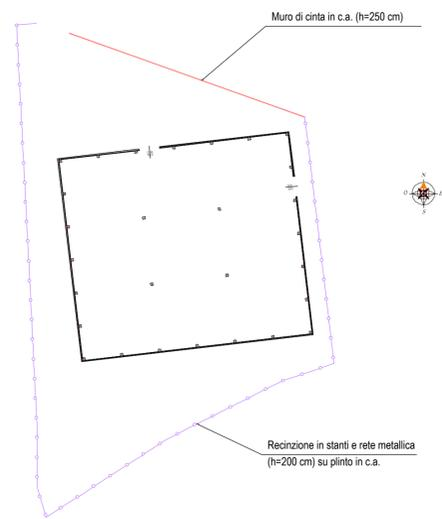
**PARTICOLARE COSTRUTTIVO RECINZIONE IN RETE METALLICA LUNGO I LATI EST - SUD - OVEST**
