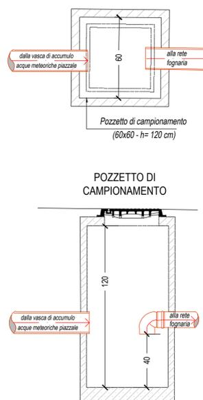
**PARTICOLARE COSTRUTTIVO DEL POZZETTO**
