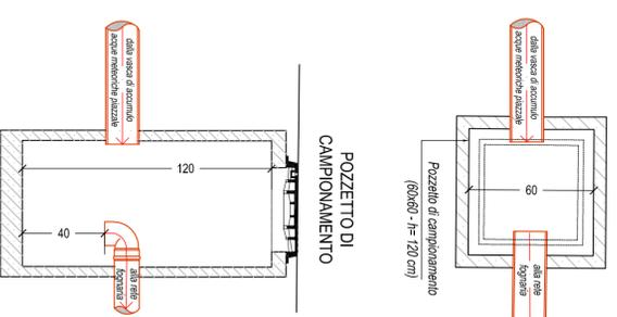
**PARTICOLARE COSTRUTTIVO DEL POZZETTO
