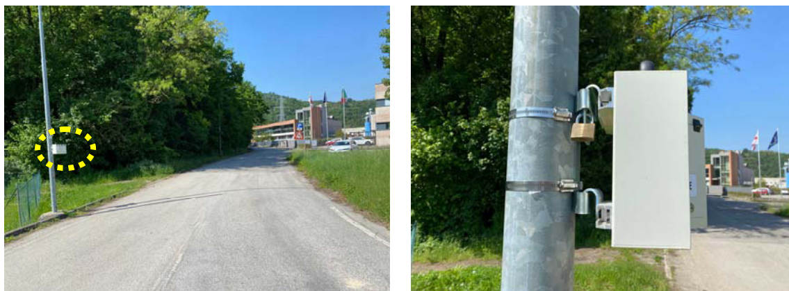
Figura 18 – Apparecchiatura conta-traffico Viacount II su via Canestrello dir.Z.I.
