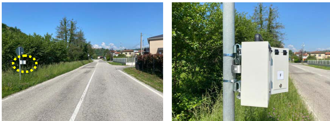
Figura 16 – Apparecchiatura conta-traffico Viacount II su SP36 direzione nord
