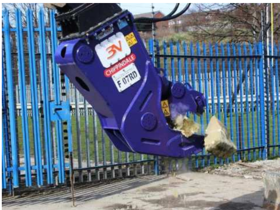
Figura 14: Pinza frantumatrice FR 20HS - Trevi Benne S.r.l.
