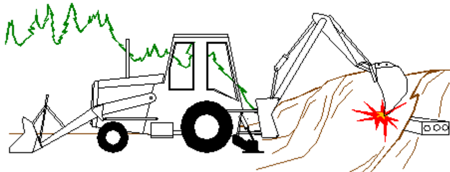
Figura 1 – Contatto con linee elettriche interrante
