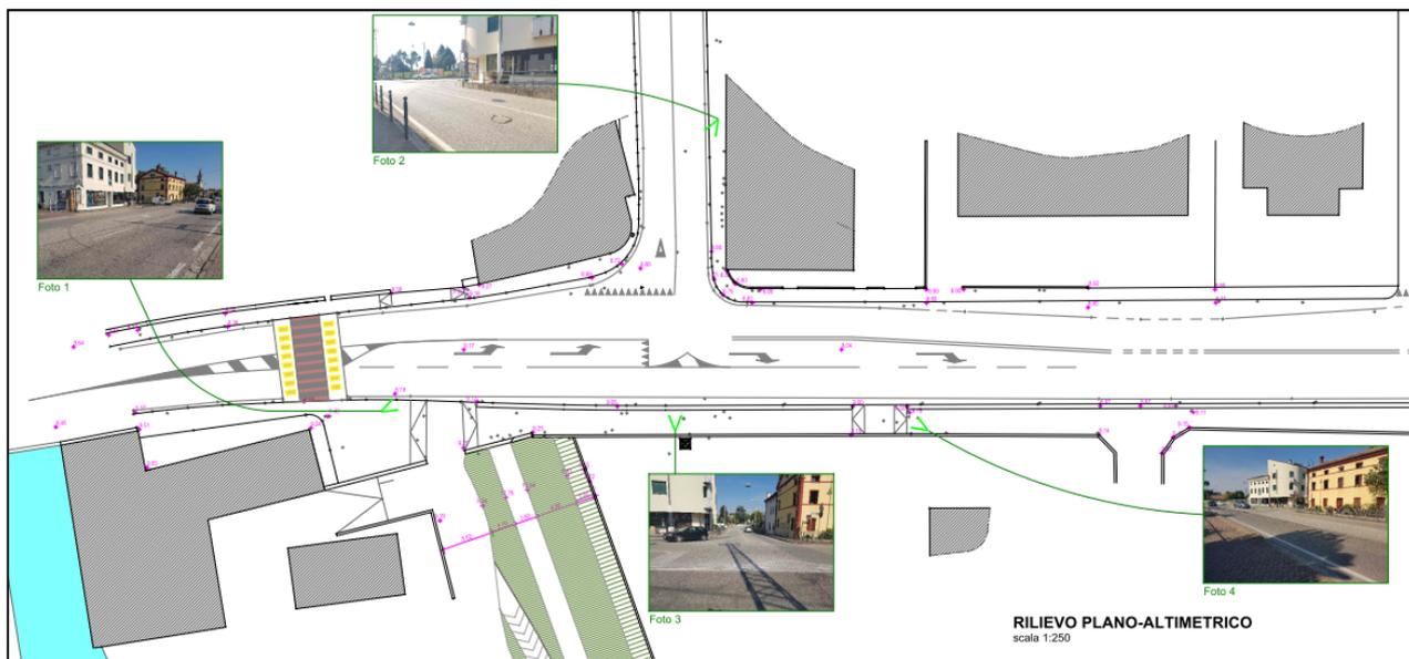
*Rilievo Plano altimetrico dello Stato di Fatto*
