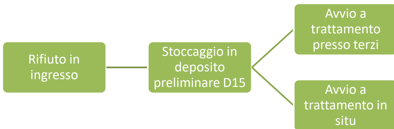
Figura 8 - Schema gestione rifiuti sottoposti al deposito preliminare D15
