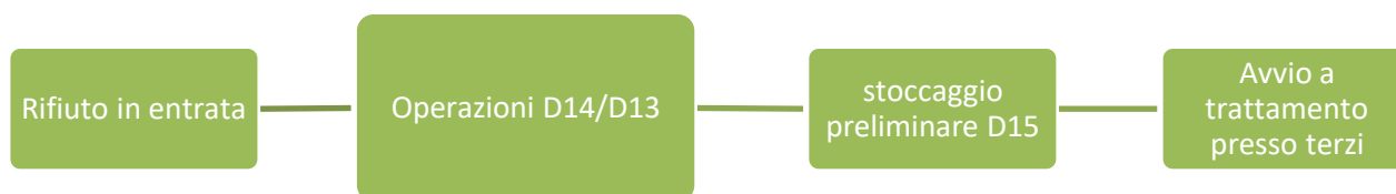
Figura 9 - Schema gestione rifiuti sottoposti al deposito preliminare D15 dopo un'operazione D14/D13
