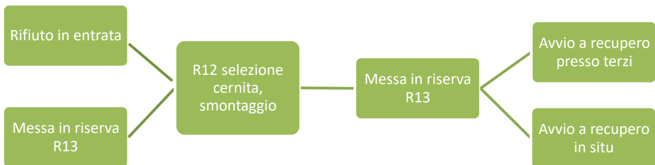
Figura 15 - Schema gestione rifiuti sottoposti all’operazione di R12 SELEZIONE, CERNITA, SMONTAGGIO.
