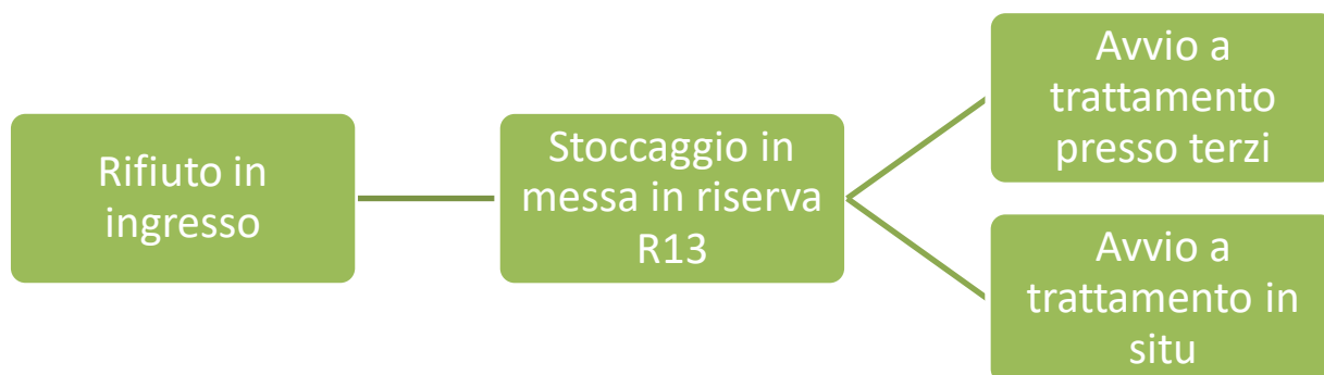
Figura 12 - Schema gestione rifiuti sottoposti alla messa in riserva R13
