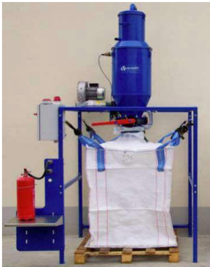
Figura 15. Esempio di apparecchiatura per lo svuotamento degli estintori a polvere
