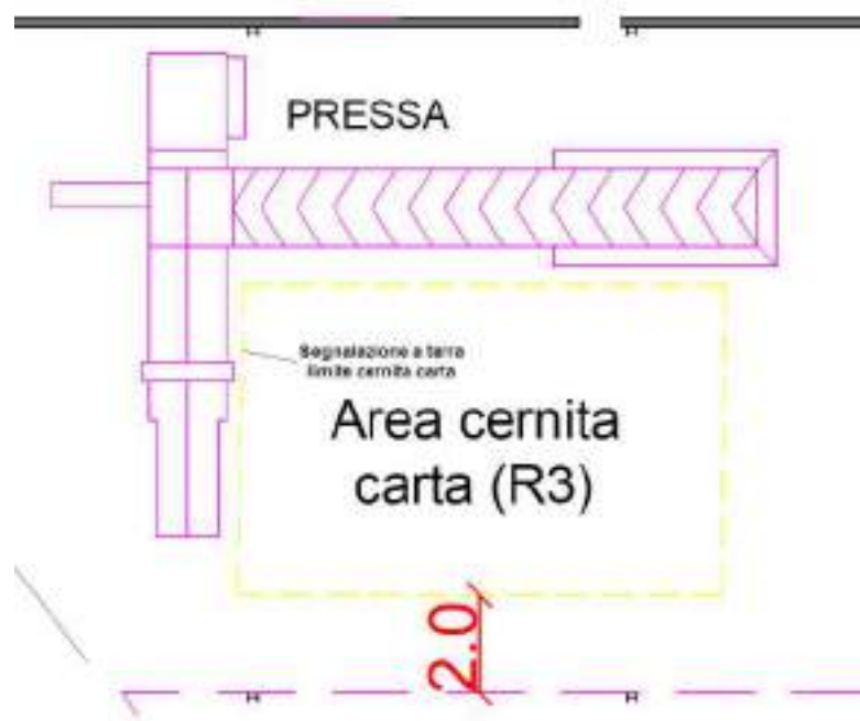
FIGURA 24. DETTAGLIO DELL'AREA CERNITA CARTA (R3)
