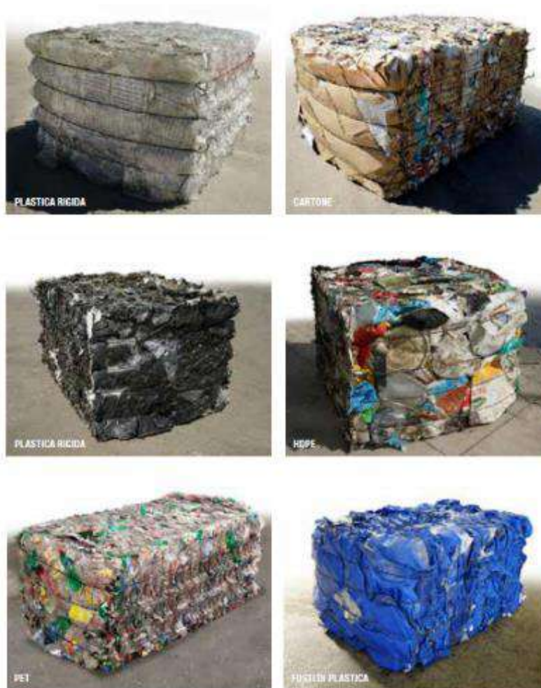
FIGURA 37. ESEMPI DI MATERIALI/RIFIUTI PRESSATI IN BALLE
