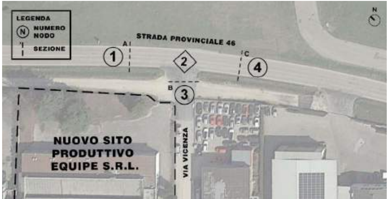
Figura 2.3 – Identificazione del nodo e delle sezioni di rilievo dei dati di traffico
