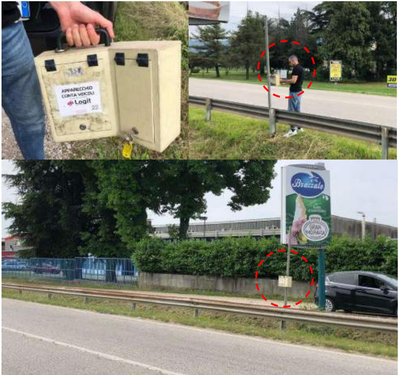
Figura 2.2 – Foto del radar utilizzato per il rilievo automatico ed installazione del medesimo lungo la SP 46
