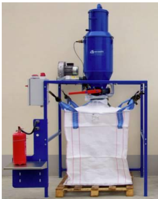
FIGURA 9. ESEMPIO DI APPARECCHIATURA PER LO SVUOTAMENTO DEGLI ESTINTORI A POLVERE
