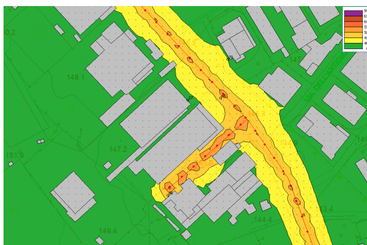
FIGURA 20. MAPPA DELLE CURVE DI ISOLIVELLO DELLA PRESSIONE ACUSTICA STIMATA RELATIVA AL TRAFFICO VEICOLARE PESANTE INDOTTO DALL'ATTIVITA' AZIENDALE.
