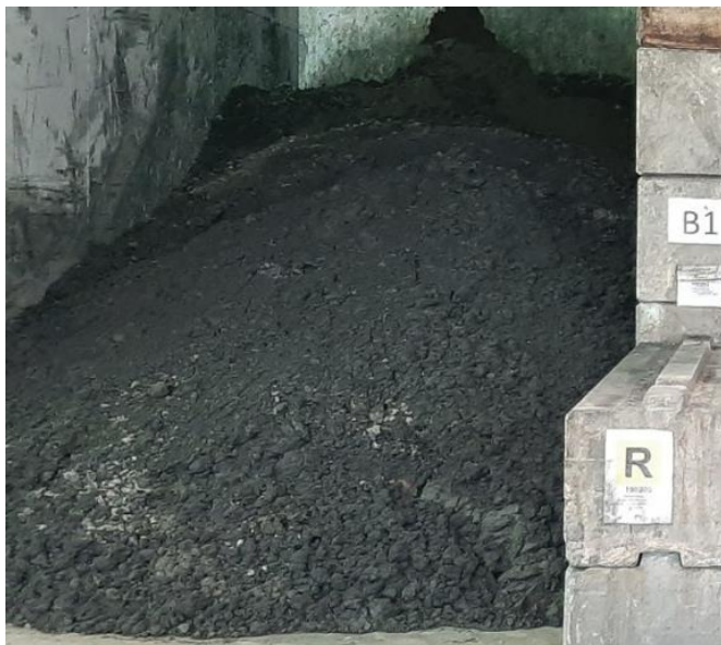
FIGURA 12. ESEMPIO DI STOCCAGGIO FANGO PALABILE PERICOLOSO.
