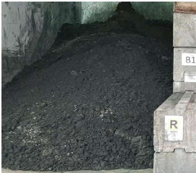
FIGURA 24. ESEMPIO DI STOCCAGGIO FANGO PALABILE PERICOLOSO.
