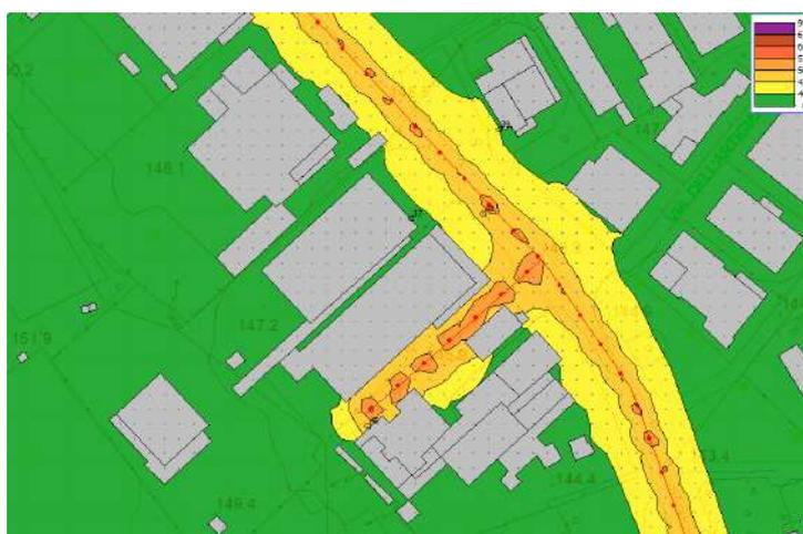
FIGURA 32. MAPPA DELLE CURVE DI ISOLIVELLO DELLA PRESSIONE ACUSTICA STIMATA RELATIVA AL TRAFFICO VEICOLARE PESANTE INDOTTO DALL'ATTIVITA' AZIENDALE.
