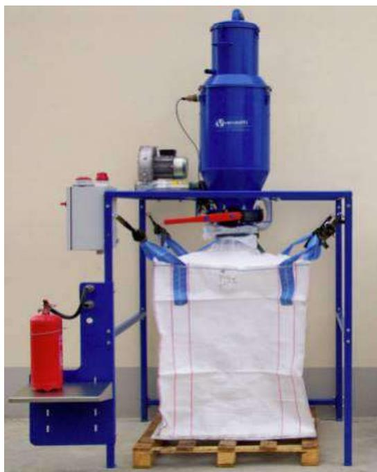
FIGURA 21. ESEMPIO DI APPARECCHIATURA PER LO SVUOTAMENTO DEGLI ESTINTORI A POLVERE
