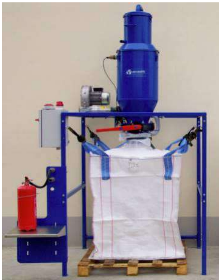
Figura 4. Esempio di apparecchiatura per lo svuotamento degli estintori a polvere
