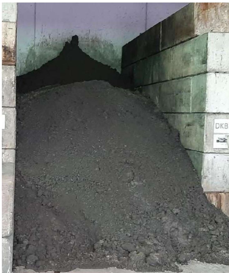
Figura 6. Esempio di stoccaggio fango palabile non pericoloso
