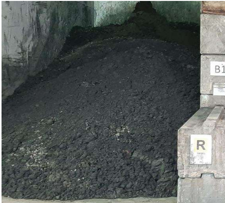
Figura 7. Esempio di stoccaggio fango palabile pericoloso
