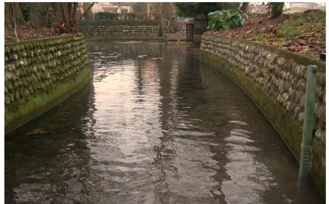
Figura 5 - Tubo idrometrico di calma installato presso R2
