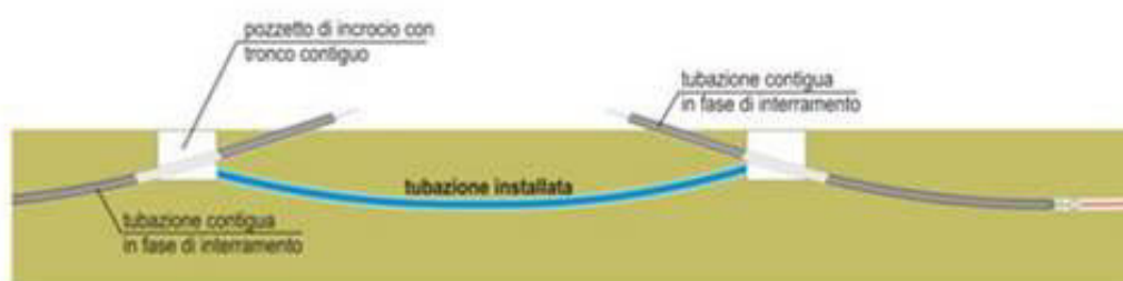
Figura 49 Messa in opera dei pozzetti
