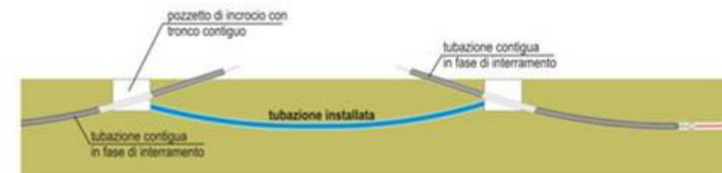
Figura 16 Messa in opera dei pozzetti
