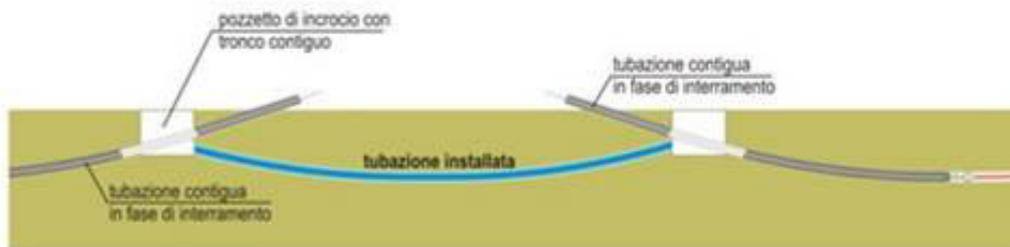
Figura 16 Messa in opera dei pozzetti
