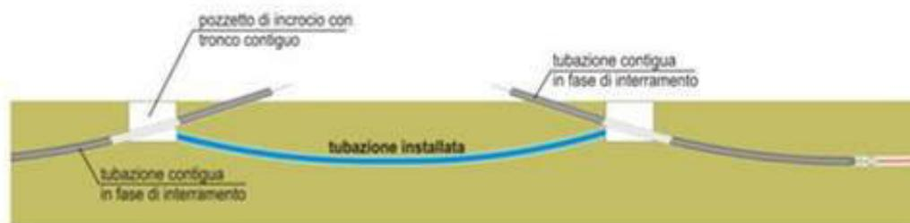
Figura 45 Messa in opera dei pozzetti
