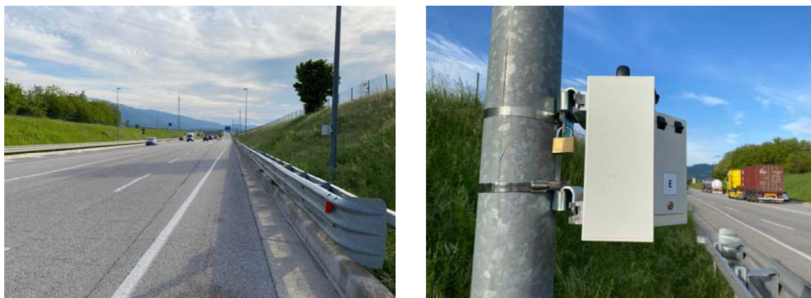
Figura 21 – Apparecchiatura conta-traffico Viacount II su viale del Lavoro - dir. Schio
