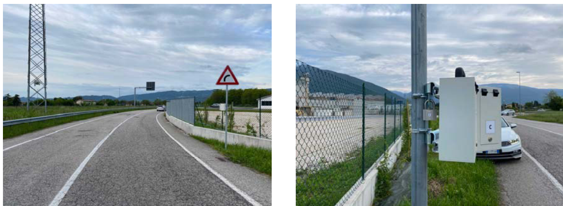
Figura 19 – Apparecchiatura conta-traffico Viacount II su via L. di Alleghe
