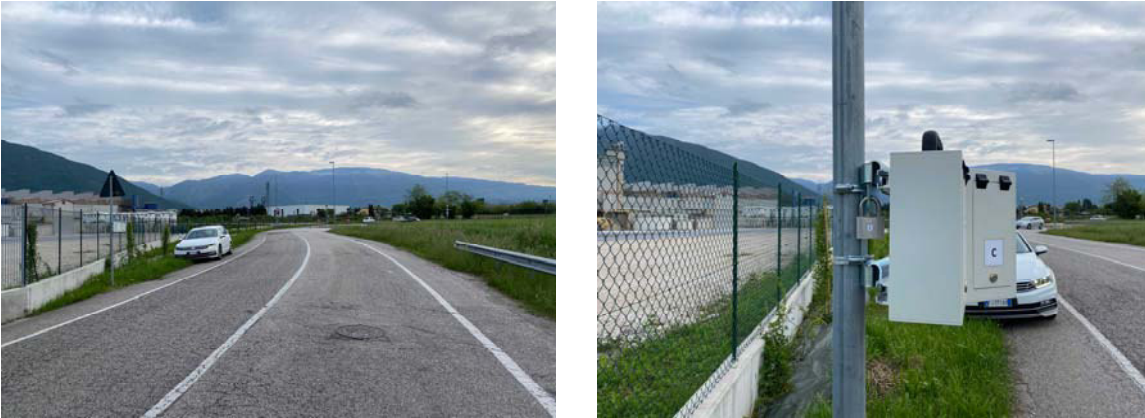
Figura 18 – Apparecchiatura conta-traffico Viacount II su via L. di Alleghe
