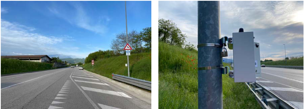
Figura 20 - Apparecchiatura conta-traffico Viacount II su viale del Lavoro - dir. Schio
