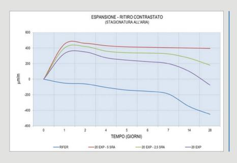
Figura 1: Ritiro/espansione nel tempo di vari Betonpav Zerojoint e di un calcestruzzo ordinario di riferimento
