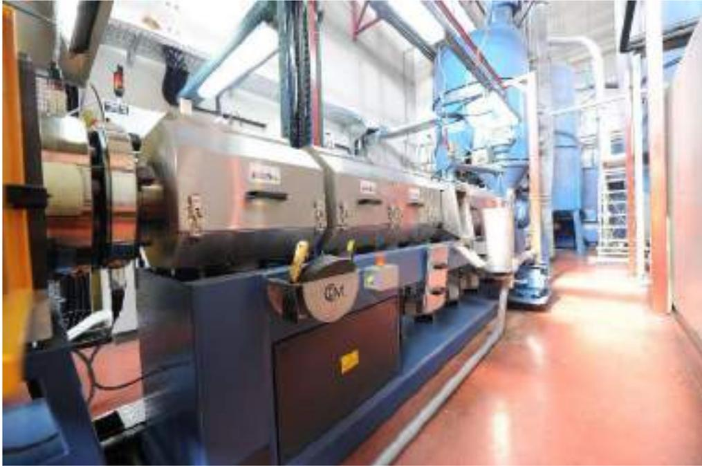
Figura 5. Estrusore; sullo sfondo a sinistra, in blu, silo di stoccaggio
