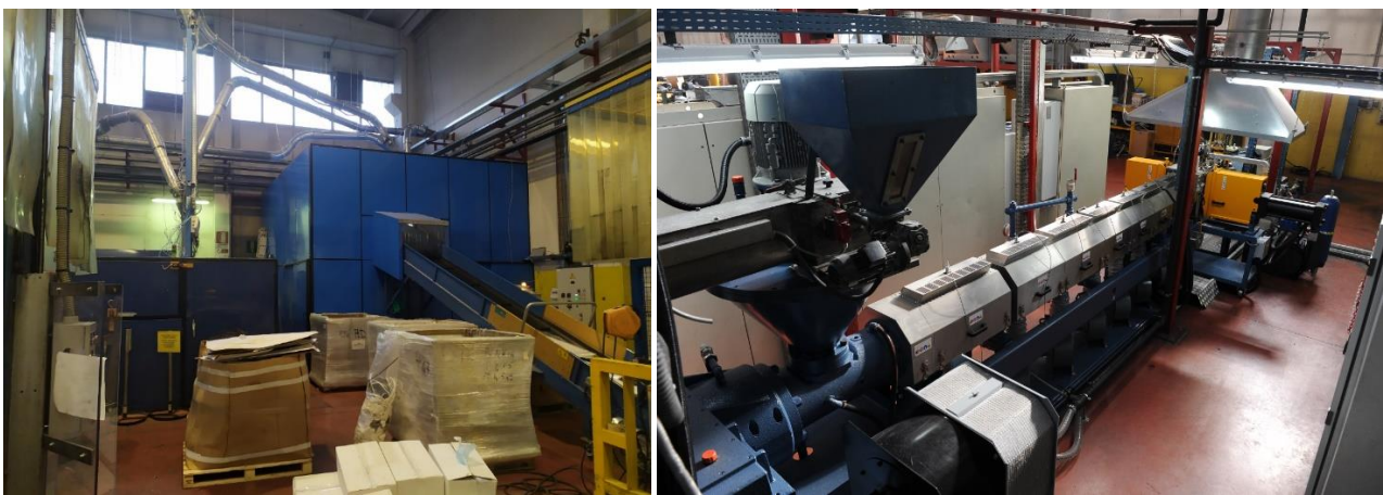
FIGURA 11. PARTICOLARI DEL MULINO (A SINISTRA) E DELL'ESTRUSORE (A DESTRA).
