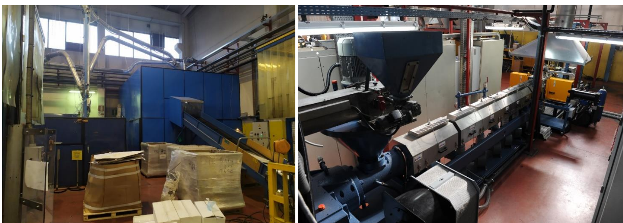
FIGURA 26. PARTICOLARI DEL MULINO (A SINISTRA) E DELL'ESTRUSORE (A DESTRA).
