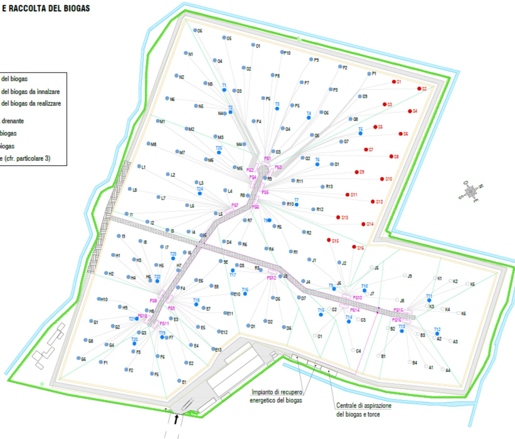
Figura 5 - Estratto da Elaborato A25 "Rete del Biogas"
