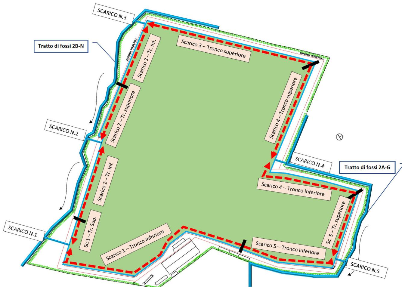
I calcoli idraulici dei vari tronchi di canaletta possono prendere le mosse dall'ipotesi di attivare il loro funzionamento una volta che i settori di copertura finale afferenti siano completamente inerbiti. In tal guisa, come indicato nel cap.4, il coefficiente di deflusso sarà di 0,1.
