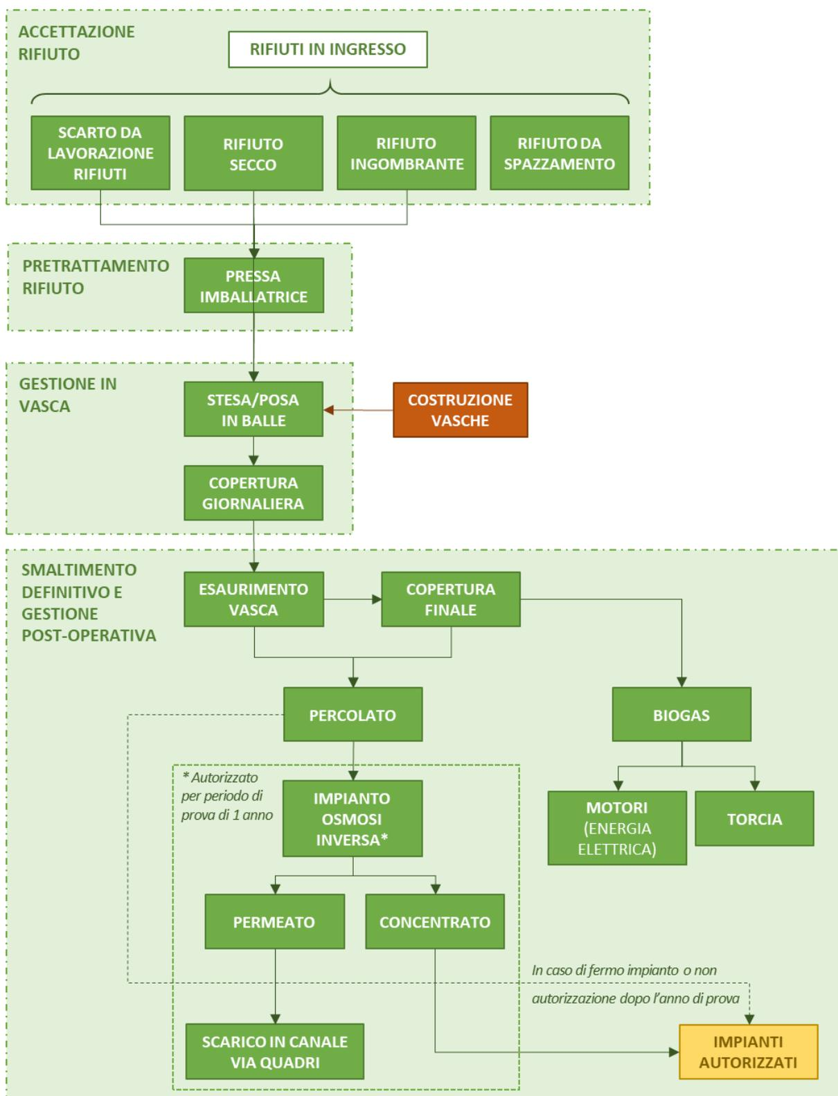
Figura 6 Schema a blocchi delle attività che avvengono in discarica.
