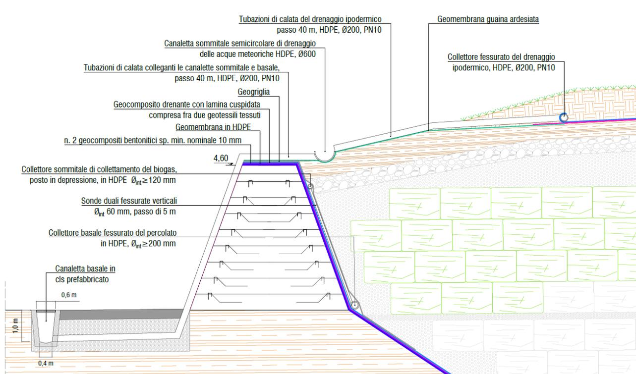
Le due canalette sopra descritte sono state sovradimensionate, al fine di garantire un'adeguata capacità di accumulo delle precipitazioni che compensi i possibili, seppur esigui, picchi di piena negli scarichi dovuti alle superfici pavimentate/edificate ed alla presenza del nuovo argine, con paramento più acclive.
