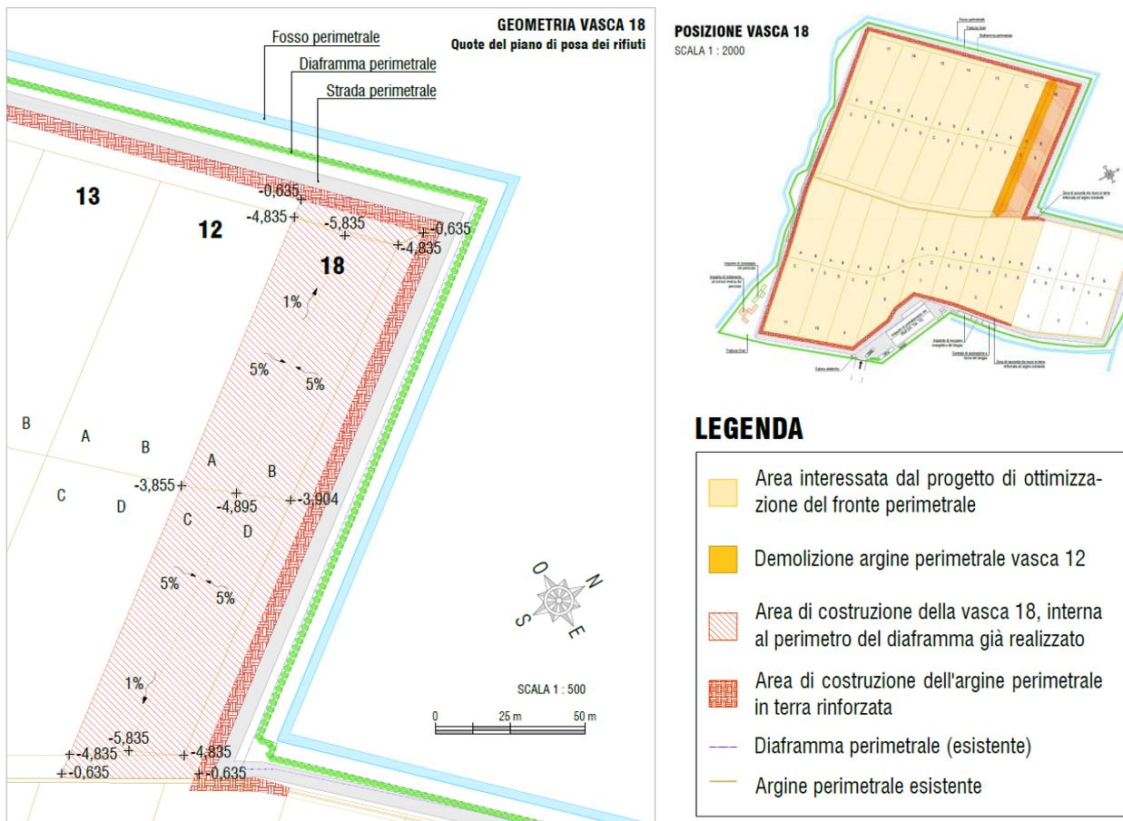
In continuità con la progettazione della discarica esistente, le due nuove semivasche 18 A-B e 18 C-D, saranno separate fra loro e dalla contigua vasca 12 tramite arginelli in argilla, con le stesse caratteristiche del fondo e protetti da geomembrana, con pendenza 1:1, altezza 1 m e larghezza sommitale di 60 cm, in modo da rendere indipendente ogni semivasca.
