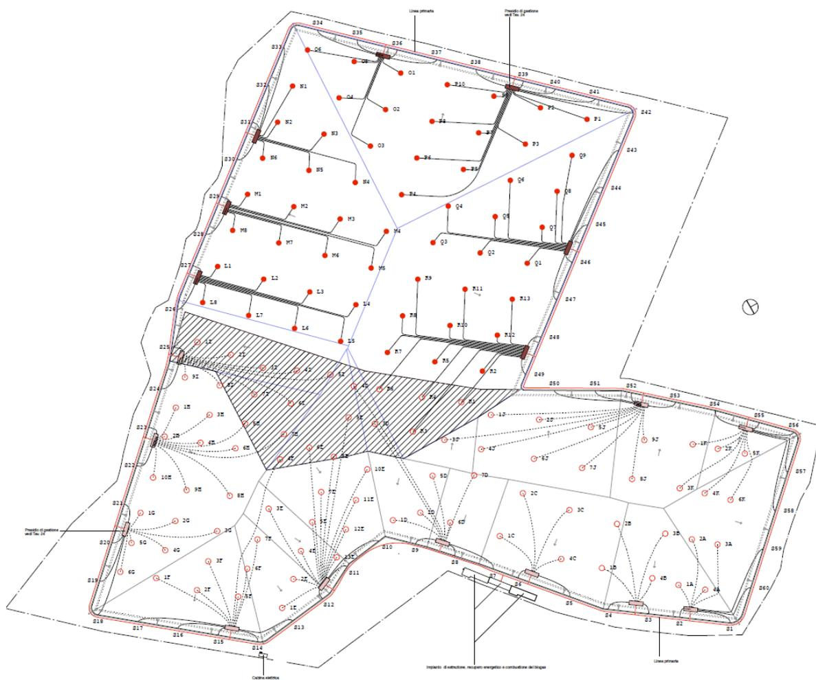
Il biogas viene estratto mediante n. 2 turbo-aspiratori da 500 m<sup>3</sup>/h cad., collocati presso la centrale di recupero energetico. Il biogas aspirato dalla discarica vecchia è avviato a recupero energetico per combustione diretta in n. 2 motori dalle seguenti caratteristiche:
