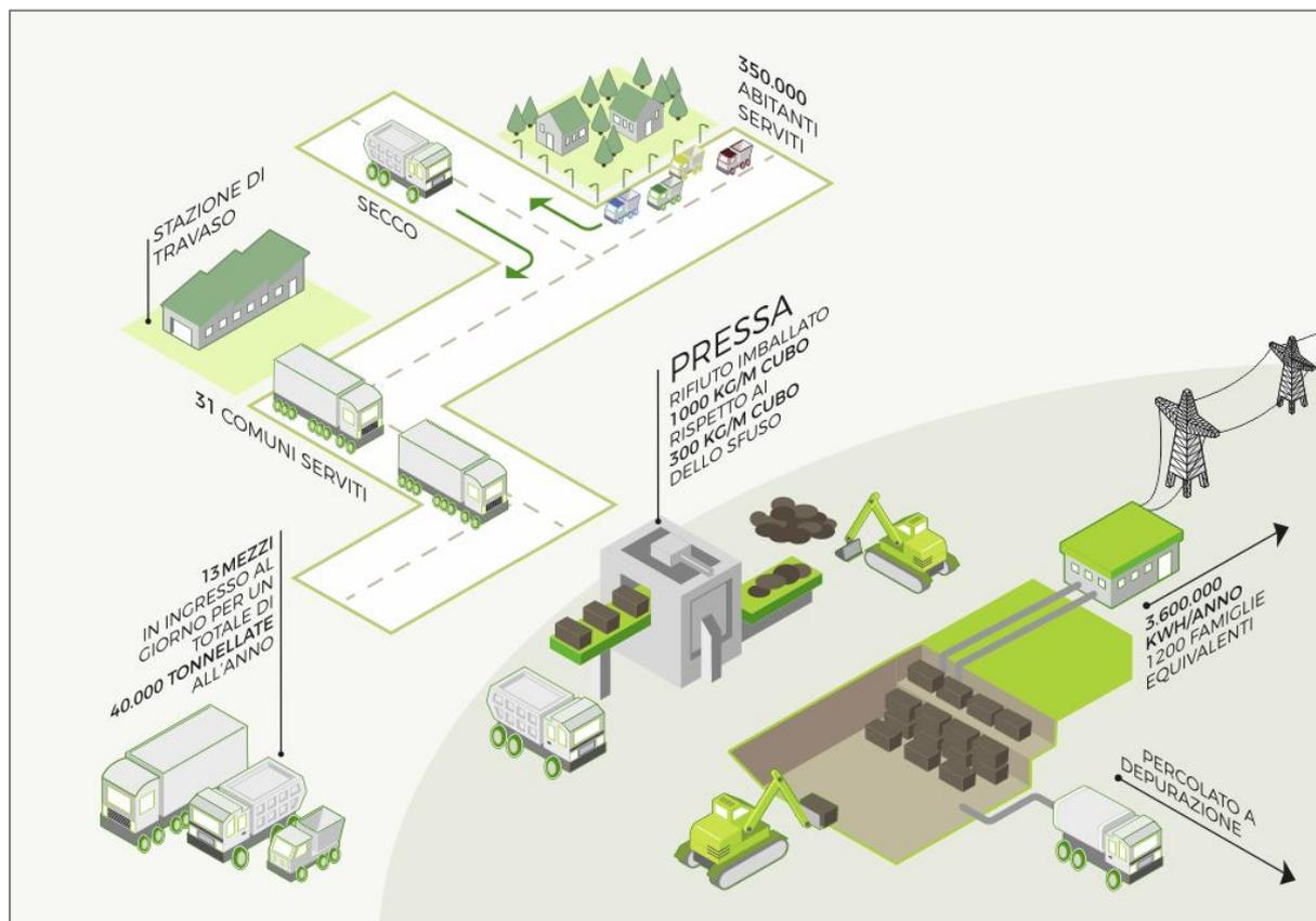
Figura 5 Il sistema di raccolta e smaltimento presso la Discarica di Grumolo (sistema SIA)
