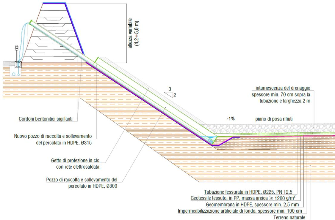
In continuità con le semivasche da 14 C-D a 12 C-D, la parte orientale del fondo vasca nel settore 18 D sarà sagomato in modo che il punto più depresso si trovi in corrispondenza della base del pozzo saliente, posto sul lato nord della semivasca e che garantirà l'emungimento del percolato proveniente dalle vasche da 14 C-D a 18 C-D.
