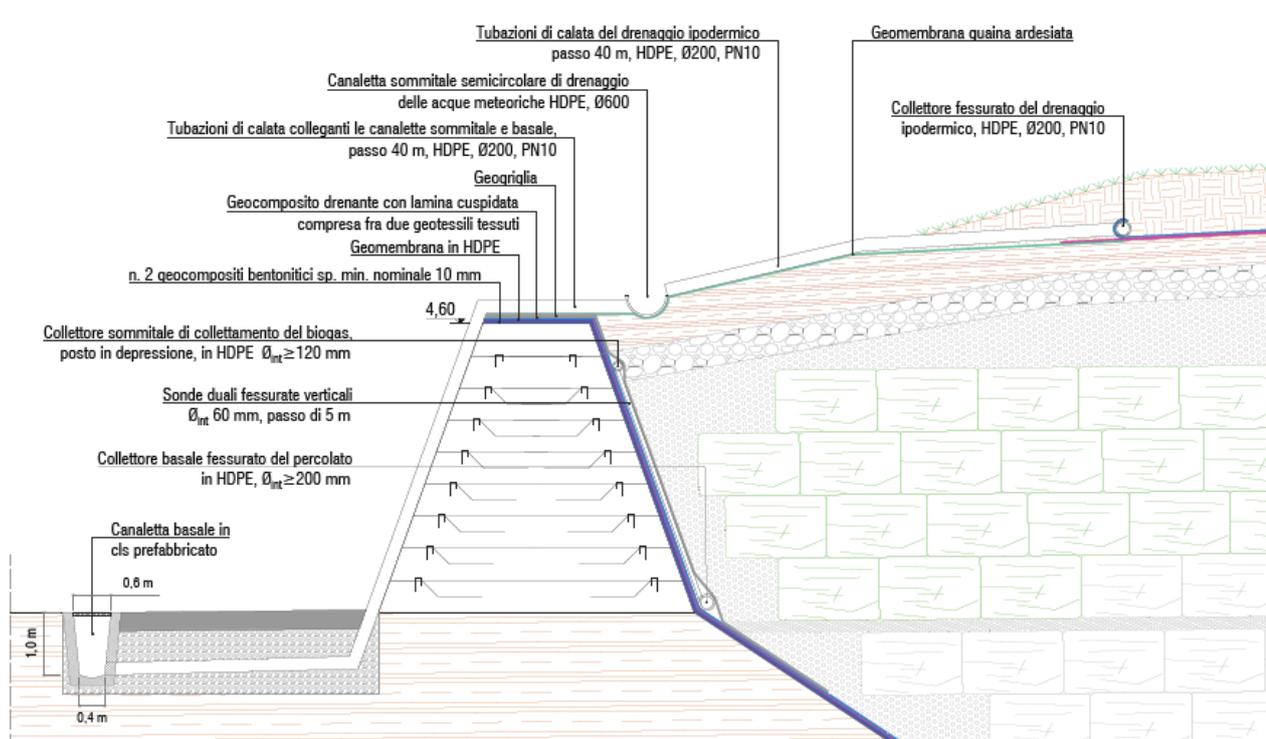
Figura 90 - Particolare dell'Argine perimetrale di terra rinforzata (Argine) - estratto da T11
