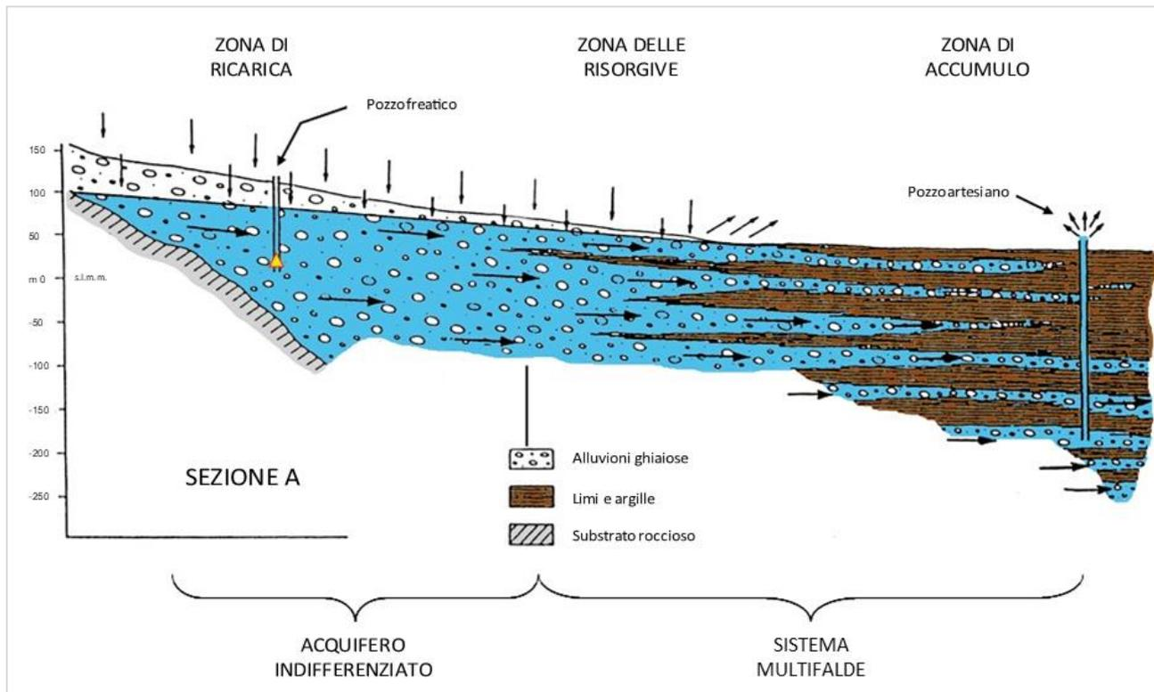
Figura 56 - Schema idrogeologico dell'alta e media pianura Veneta – Fonte: (ARPAV, 2008).
