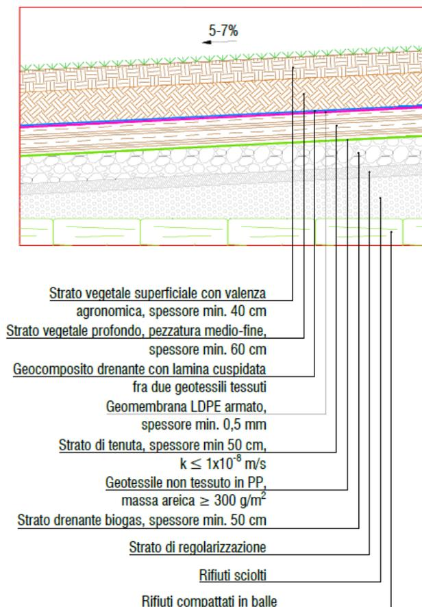
Figura 91 - Estratto da T11 - particolare pacchetto di copertura
