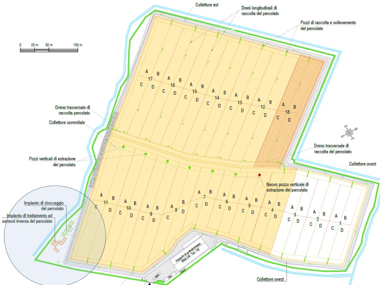
Figura 93- Estratto da Elaborato A24 Rete Percolato, con l'individuazione dell'Impianto di Depurazione ad Osmosi Inversa.
