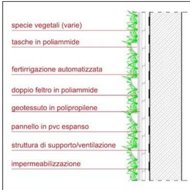
Figura 83 - Il sistema di strati funzionali che compongono un muro verticale.
