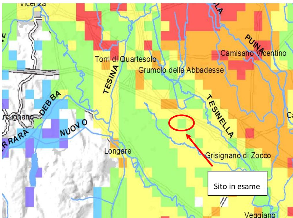
Figura 35 - Estratto cartografia della vulnerabilità intrinseca della falda freatica
