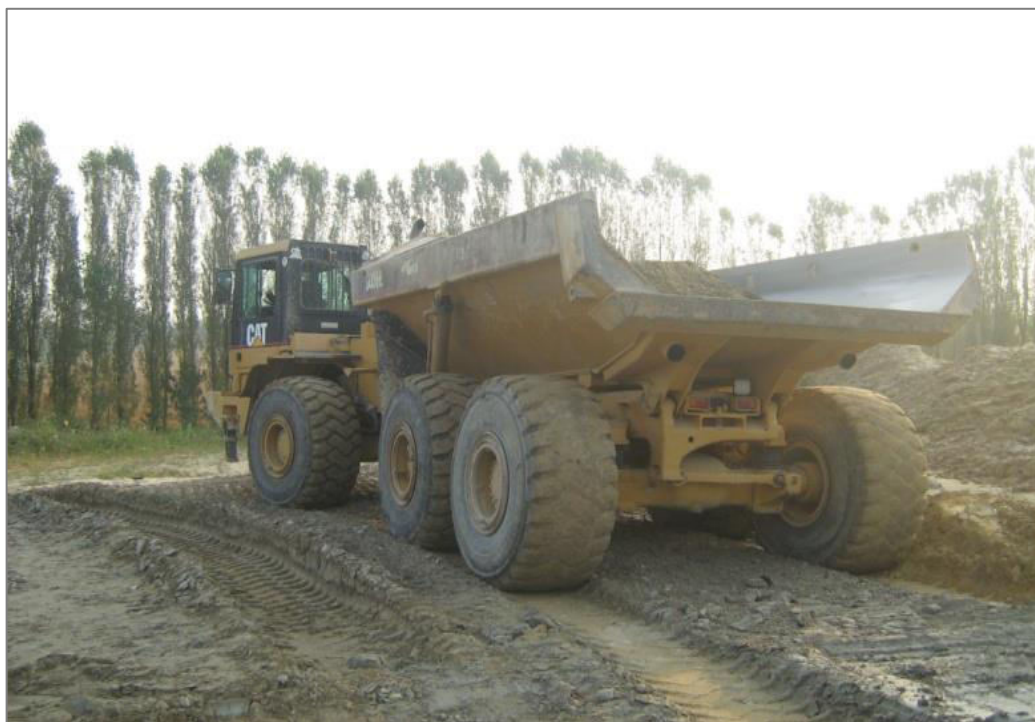
Mezzo compattatore: DUMPER - Peso del mezzo: 30 ÷ 50 [t]
