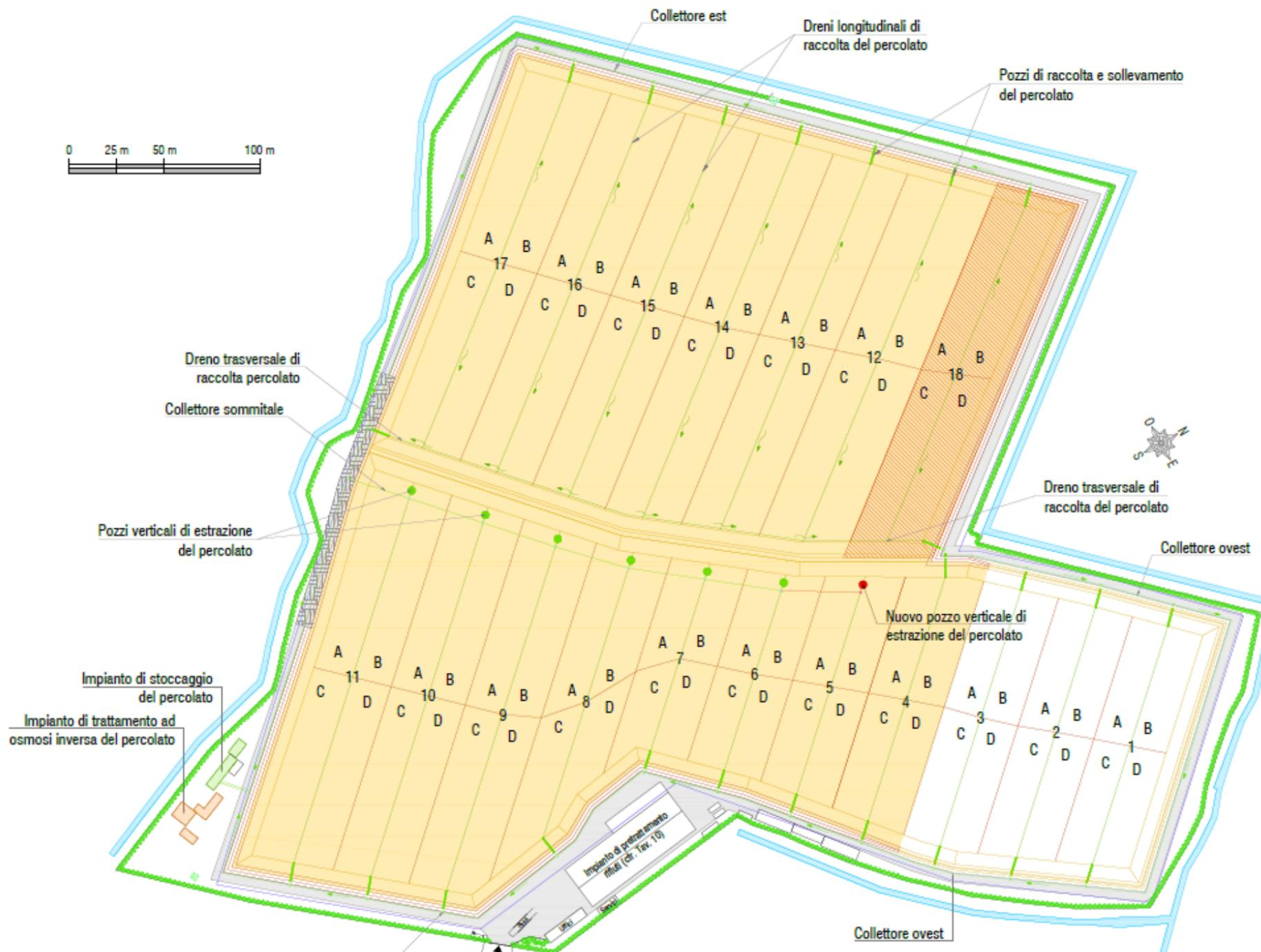
Figura 4 - Elaborato A24 Rete Percolato, con l'individuazione dell'Impianto di Depurazione ad Osmosi Inversa
