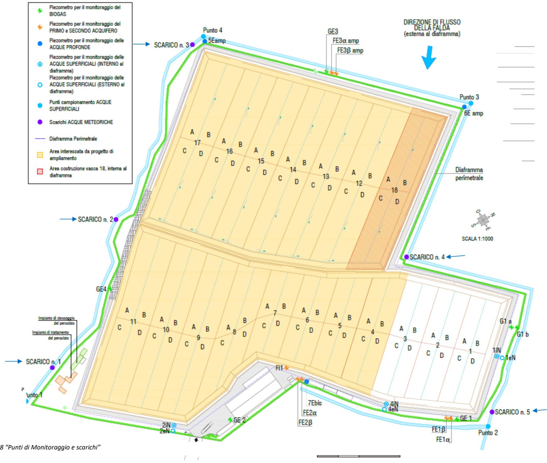
Figura 6 - Estratto da Elaborato A28 "Punti di Monitoraggio e scarichi"
