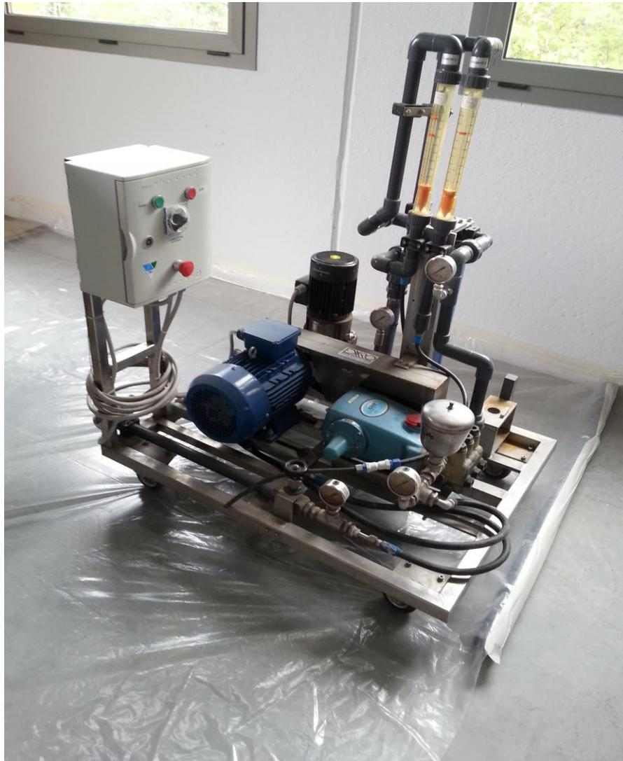
Per l'alimentazione dell'impianto pilota è stata utilizzata una cisterna da 1 m<sup>3</sup>, all'interno della quale il percolato viene "condizionato" tramite iniezione controllata di acido solforico, mediante pompa dosatrice, al fine di ottenere un valore di pH di 6,3/6,4, ideale per il trattamento ad osmosi inversa.
