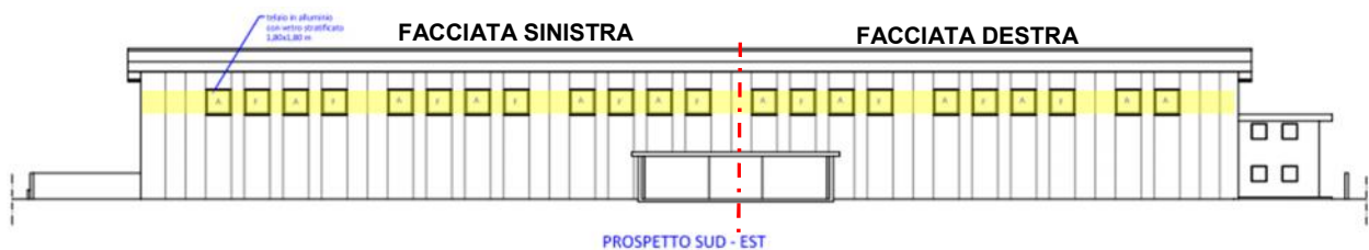
Fig.4: Simulazione parete est per applicazione norma UNI EN ISO 12354-4
