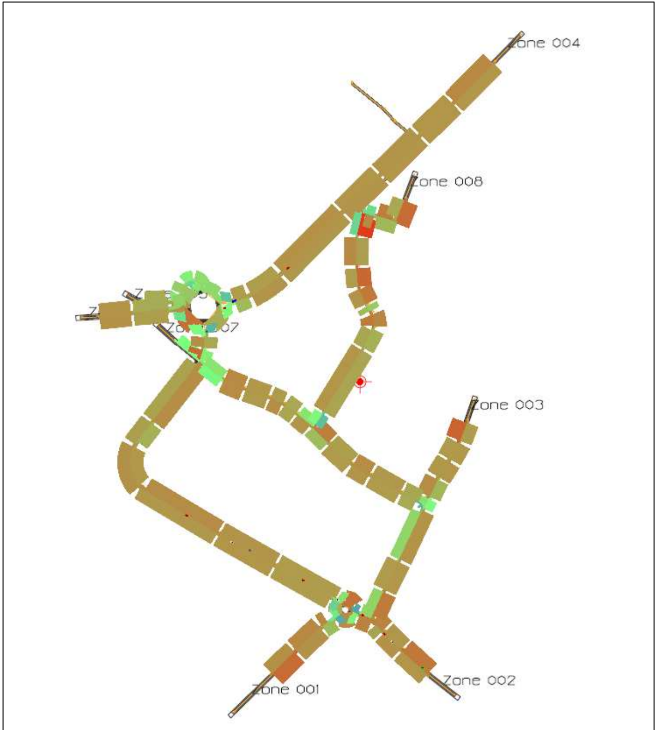
Stato di Progetto SDP, orario 17:45 – 18:45: Velocità (verde <math>< 40 \text{ km/h}</math>, marrone <math>< 55 \text{ km/h}</math>, arancione <math>\leq 60 \text{ km/h}</math>)
