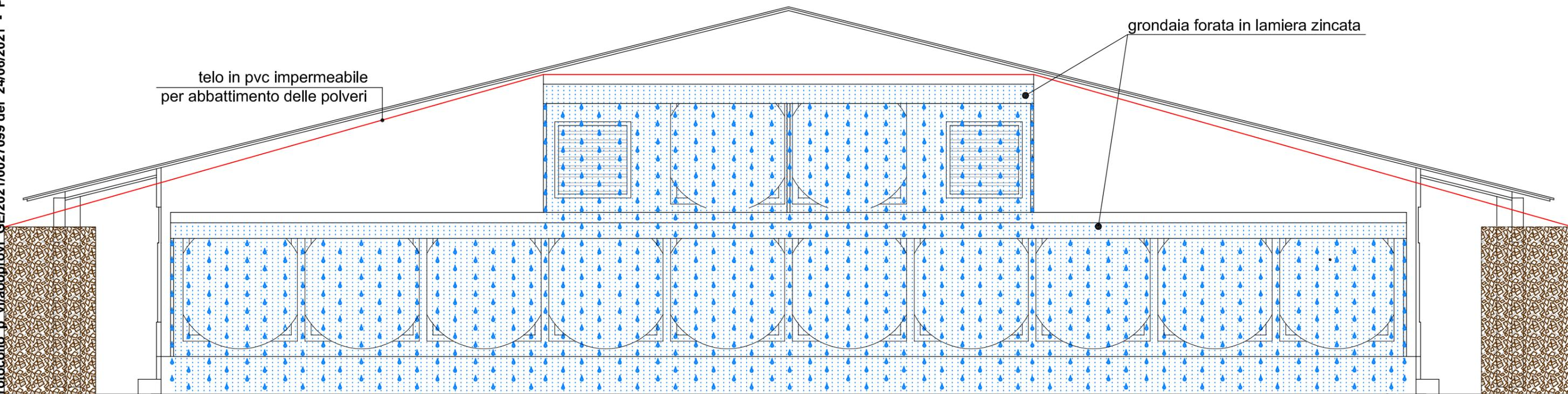
SEZIONE B-B in scala 1:50 a dimostrazione del percorso dell'acqua
