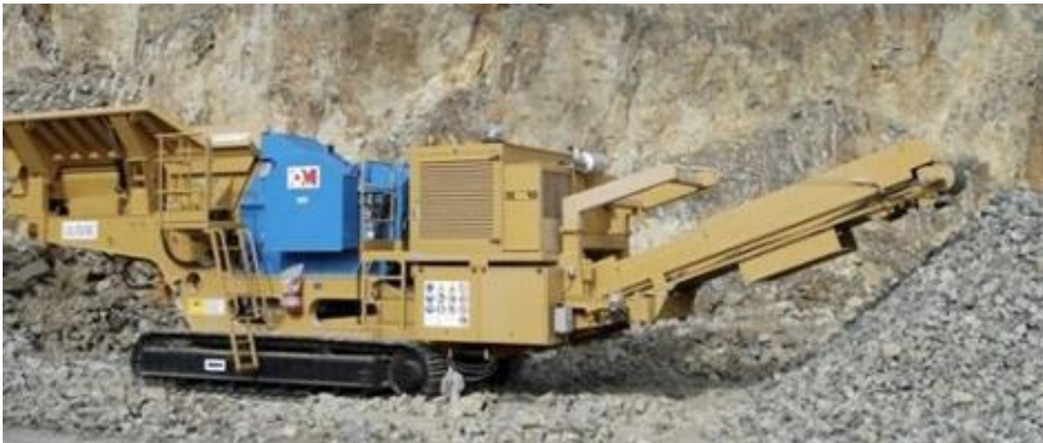
Figura 16. Frantoio semovente a mascelle OM CRUSHER ULISSE
